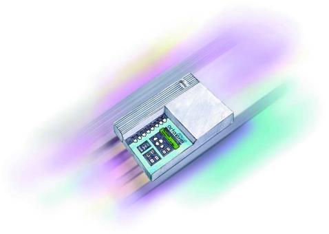
Ein erkennbarer Toncode oder Ihr eigener eingesprochener Text. Für Meldungen über eine Personenrufanlage verfügt der Octalarm-T pro Alarmkanal über vorprogrammierte Meldecodes. Diese können Sie bei Bedarf selbst einstellen. Abhängig von der Personenrufanlage wählen Sie Toncodes,
