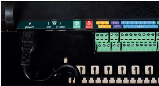
En plaçant le câble d'alimentation dans le support en forme de S, on crée une décharge de traction. Outre la protection de l'entrée, ceci permet d'éviter de débrancher le câble en tirant inopinément dessus. Lorsque le câble d'alimentation est remplacé par un câble autre que celui fourni par Adésys, celui-ci doit être conforme à la norme CEI 60227-1.
