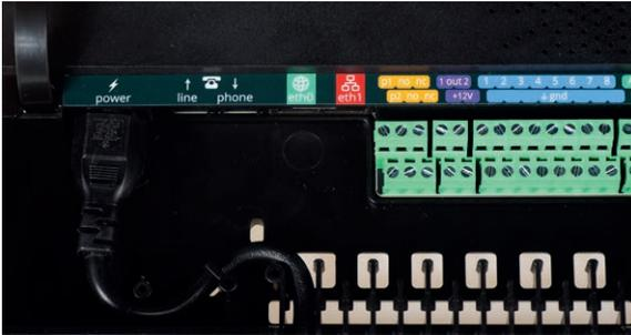
En plaçant le câble d'alimentation dans le support en forme de S, on crée une décharge de traction. Outre la protection de l'entrée, ceci permet d'éviter de débrancher le câble en tirant inopinément dessus. Lorsque le câble d'alimentation est remplacé par un câble autre que celui fourni par Adésys, celui-ci doit être conforme à la norme CEI 60227-1.
