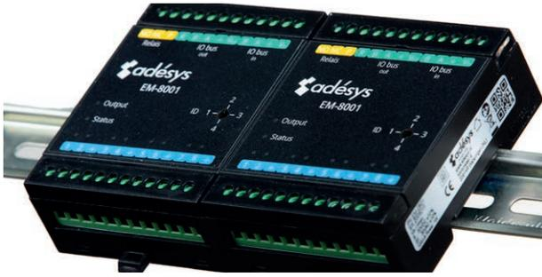
Avec l'EM-8001, le nombre d'entrées de l'Octalarm-Touch Pro peut être étendu à 16 et même 24 entrées (maximum 2 modules par détecteur). Les EM-8001 sont connectés à l'Octalarm-Touch Pro via le bus d'E / S (RS485).
