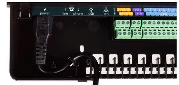
Insérez le câble d'alimentation fourni dans le support en forme de S, ce qui crée une décharge de traction.
